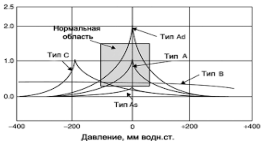
Рисунок 10 – Типы тимпанометрических кривых по J. Jerger
